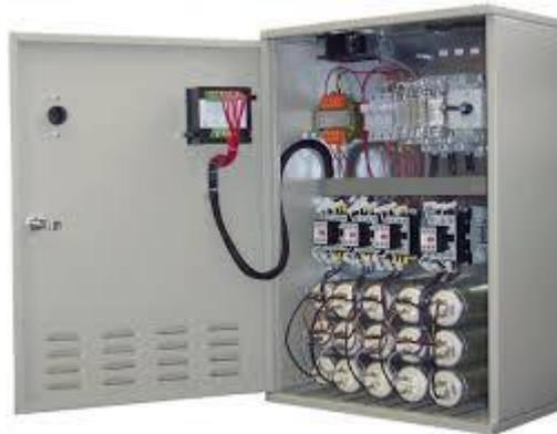
In presenza di carichi che assorbano potenze variabili nel tempo e con contemporaneità altrettanto variabili è più conveniente invece intervenire con un rifasatore a gradini e a controllo automatizzato che possa seguire nel tempo le diverse richieste di potenza capacitiva.
