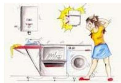
Le sovracorrenti possono essere prodotte da un abbassamento del valore di resistenza inserito nel circuito o da una maggior richiesta di potenza da parte dell'utilizzatore.
