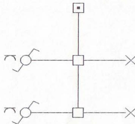
N.B. Lo schema unifilare va completato con l'indicazione del numero dei conduttori e della loro sezione per ogni tratto di condotta
