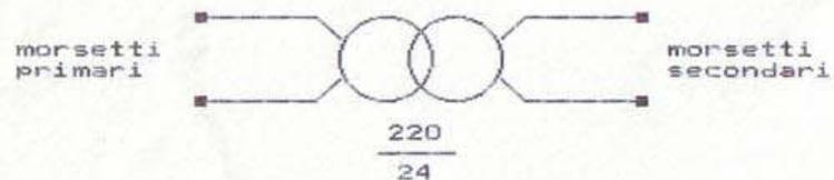
Il trasformatore e' una macchina in grado di variare il valore della tensione tra primario e secondario, aumentandolo o diminuendolo. Il rapporto  $V1/V2$  si chiama rapporto di trasformazione. Un rapporto inverso esiste tra le correnti, in modo che risulti sempre verificata la relazione
