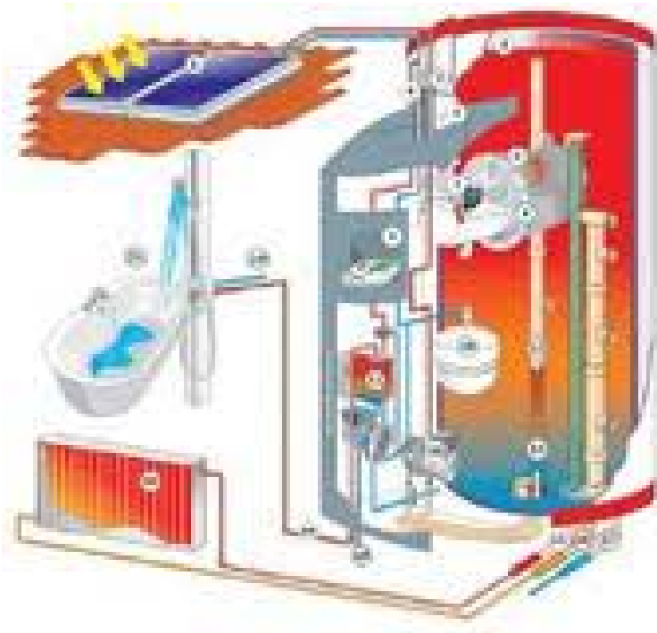
Caldaia a condensazione integrata con impianto solare termico
