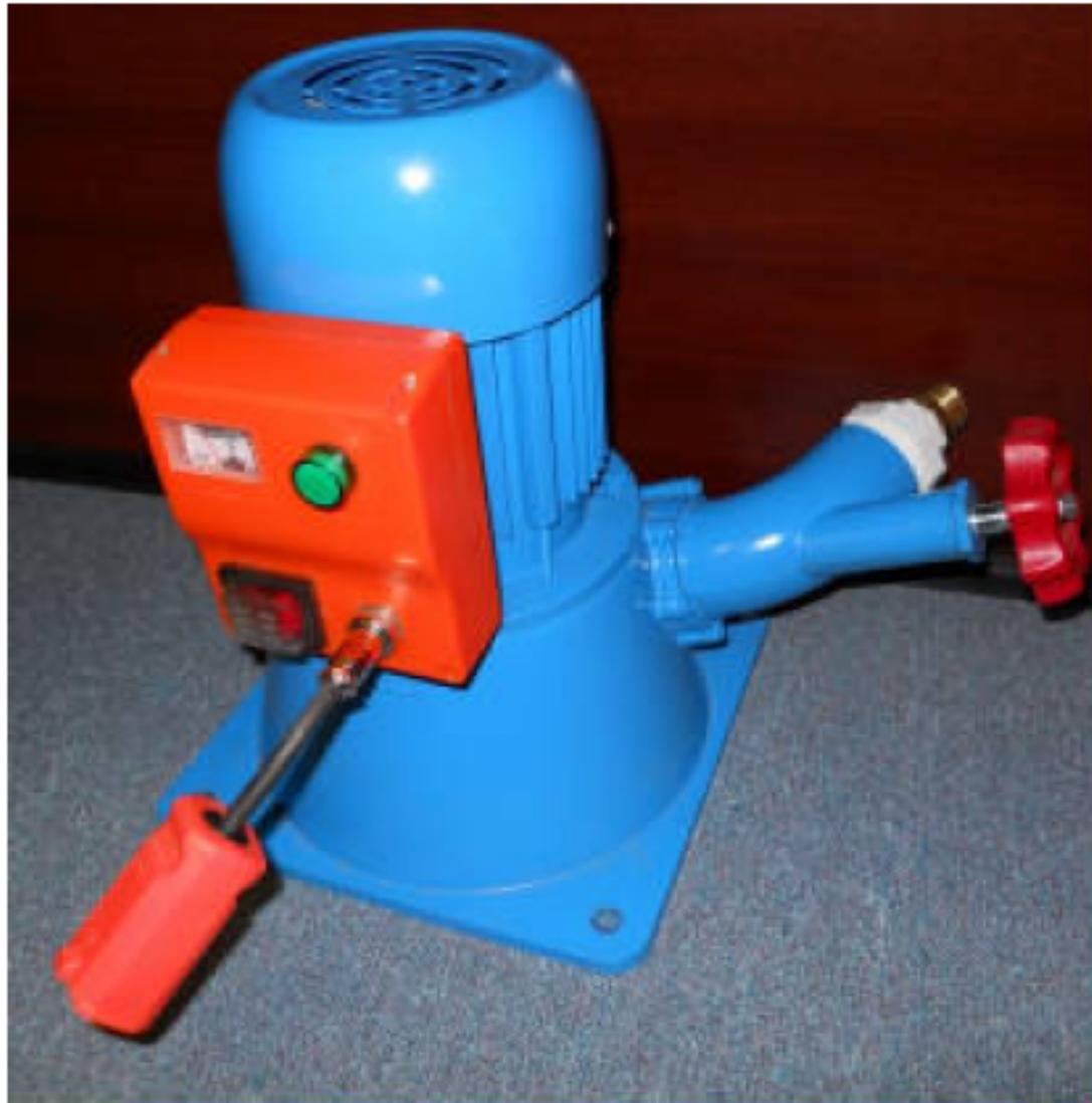
*Una turbina da 300 watt utilizzabile in un mini-impianto idroelettrico fai-da-te.*
